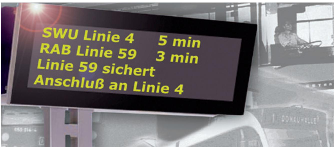
Die dynamische Fahrgastinformation visualisiert die Anschlusssicherung, welche durch die Vernetzung von Betriebsleitsystemen erreicht wird.
