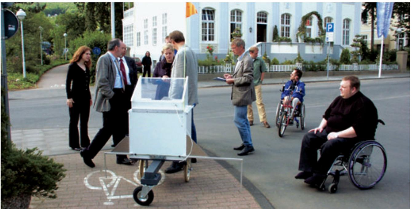
Mit einem eigens entwickelten Messfahrzeug wurden in Zusammenarbeit mit Vertretern von Behindertenverbänden halbautomatisch Daten zur Erreichbarkeit von Zielen mit Rollstühlen erfasst.
